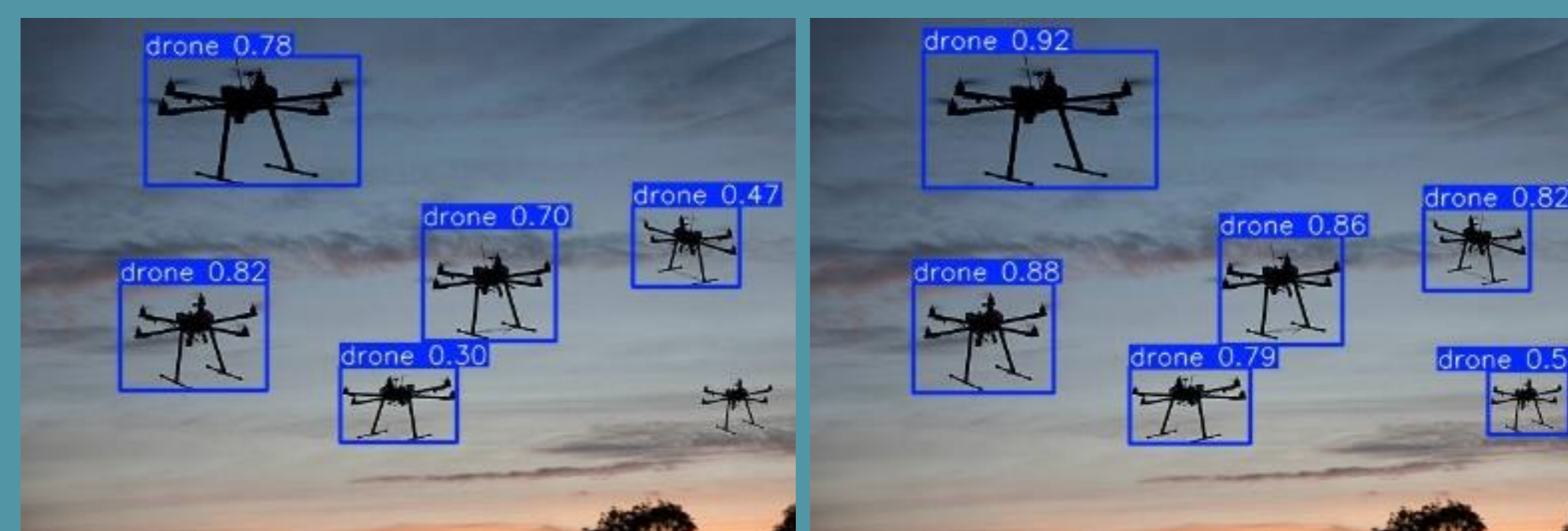
圖五、訓練40次與60次的模型在實際預測上的差異 左：40 epochs 右：60 epochs
